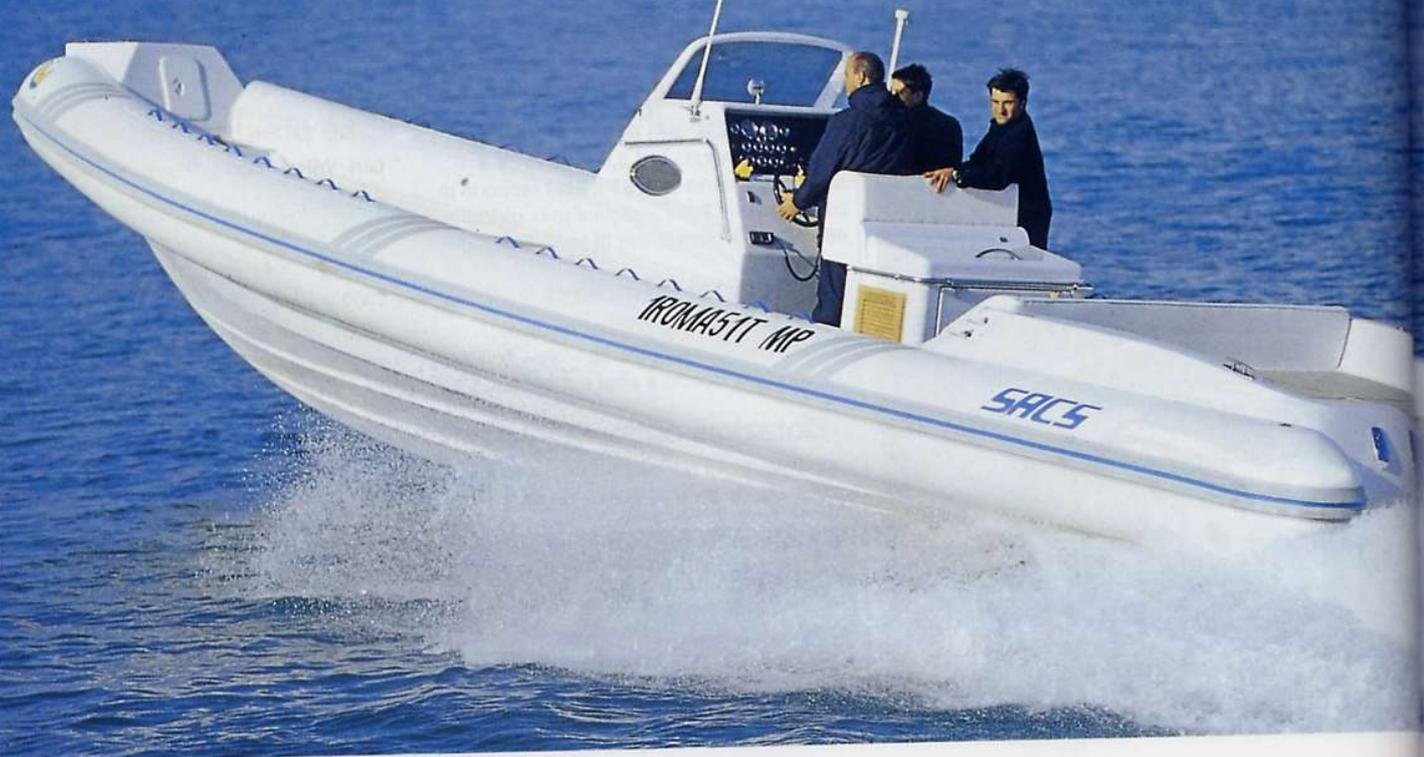
Maxi tender di alte prestazioni. Dotato di trasmissioni di superficie e due motori da 440 cv per una velocità massima di 50 nodi.
